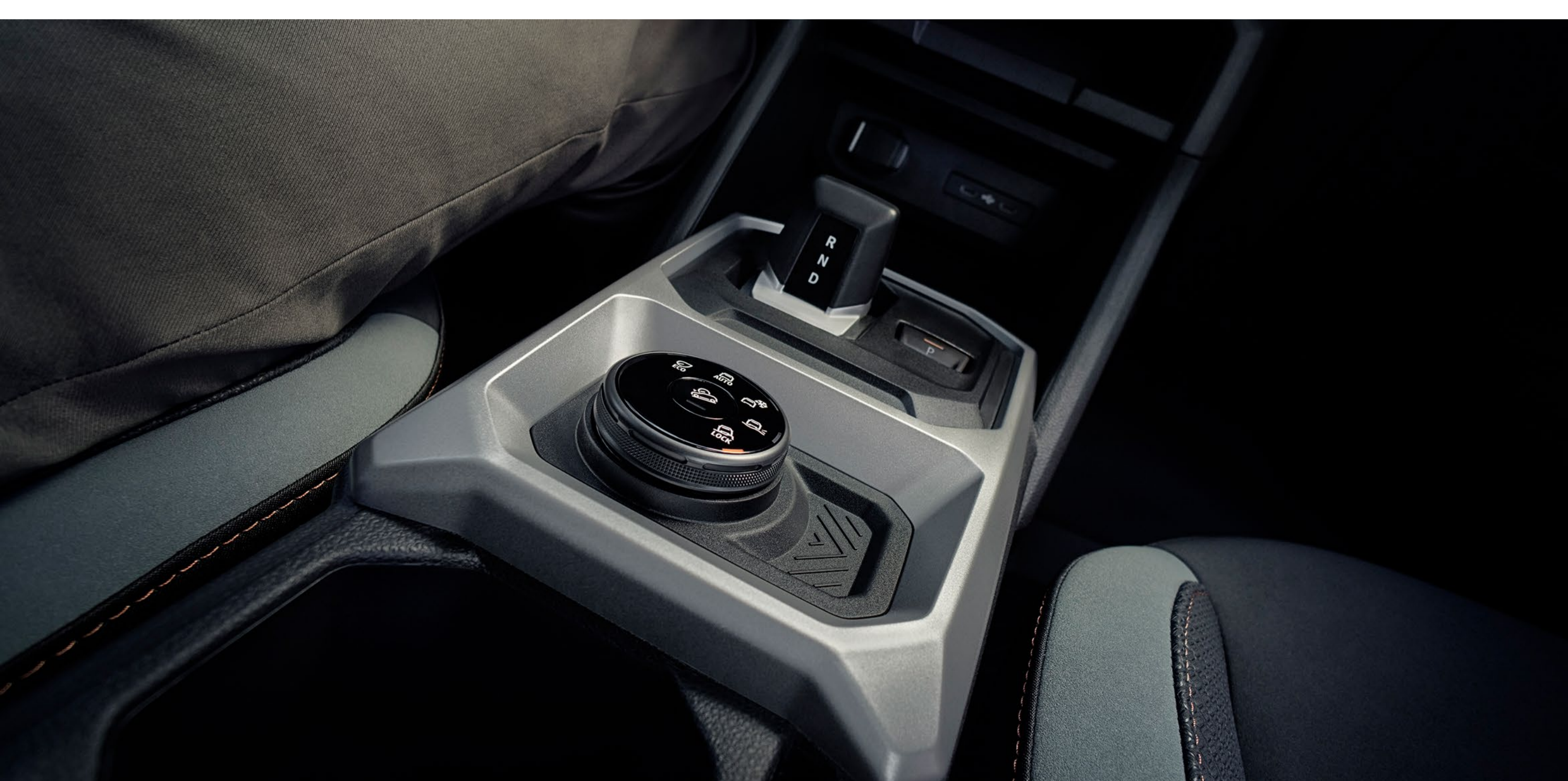
6-växlad automatväxellåda och körprogramsväljare
