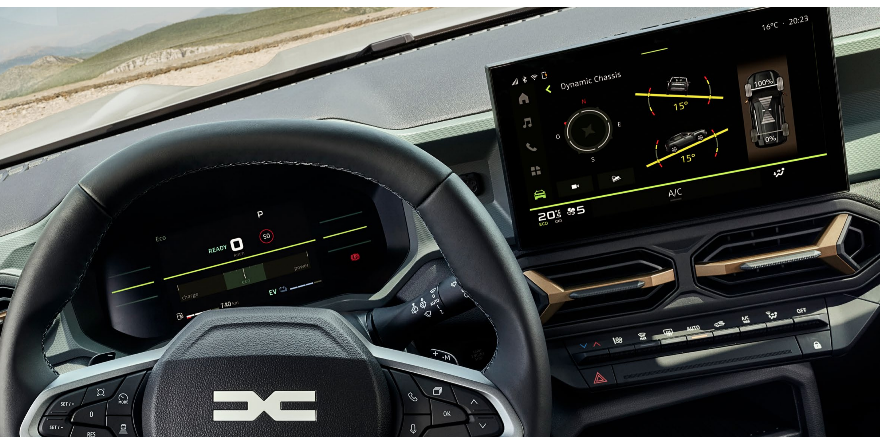
Pekskärm med 4x4 information: lutningsvinkel och kraftfördelning
